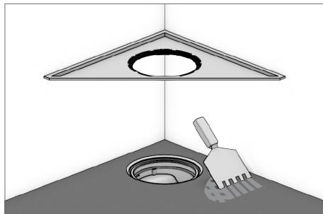
**FI** Kiinnitä kehys laattalaastilla vedeneristyksen päälle. Älä irrota säätörengasta.
